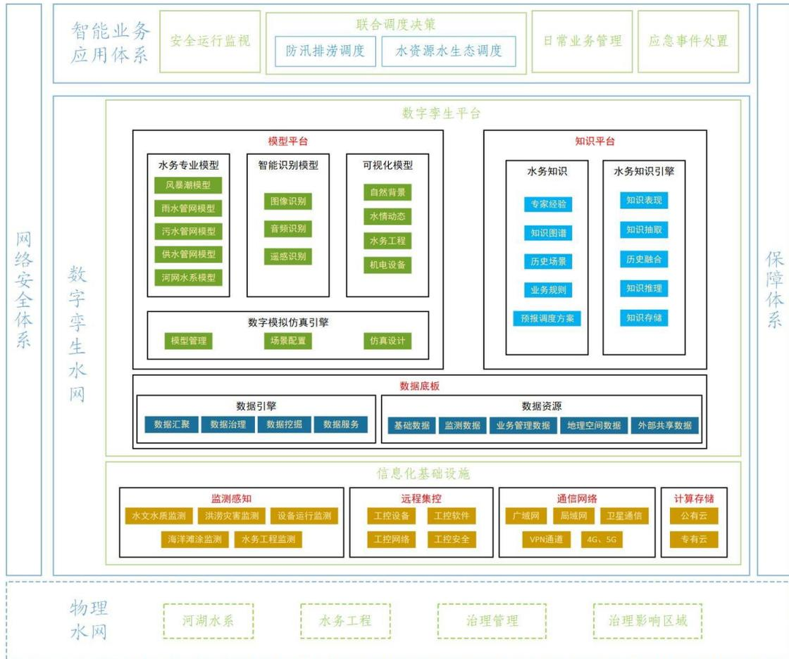
数字孪生水网平台包括数据底板、模型平台、知识平台等。其中，数据底板包括数据资源、数据模型和数据引擎，模型平台包括水网专业模型、智能识别模型、可视化模型和模拟仿真引擎，知识平台包括水网知识和水网知识引擎。
